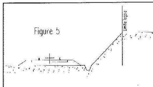
Dans le cas d'une voie posée à flanc de coteau, la limite légale à considérer est constituée par le point extrême des déblais ou remblais effectués pour la construction de la ligne et non la limite du talus naturel (figures 6 et 7).
