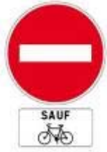
Figure 10 : Panonceau à ajouter sous les sens interdit
